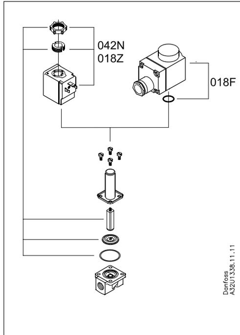
El kit de piezas de recambio contiene un botón de bloqueo, una tuerca para la bobina, armadura con clapet y muelle, y un diafragma. Para EV220B6 y 10, el kit de repuestos también incluye una junta tórica.
